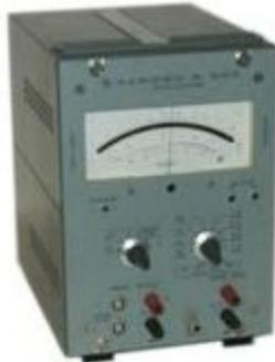
Es ist ein Messgerät, das mit Batterien betrieben wird. R&S gibt an, dass die Stromentnahme nur 1 mA ist. Daher kann man davon ausgehen, dass die Lebensdauer der Batterie mehrere Jahre sein wird. Und so geriet dieses tolle Messgerät vermutlich total in die Vergessenheit, denn alle Batteriehalter waren vom ausgelaufenen Elektrolyt zersetzt und nicht mehr verwendbar.
