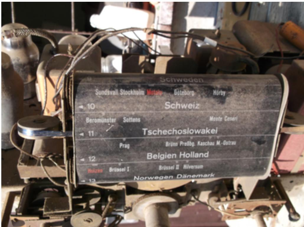
auf- und abgewickelt. Diese Rolle habe ich schonend gereinigt. Denn eine chemische Zersetzung des Seils sollte nicht durch Salze verursacht werden. Ein leichtes Einölen(säurefrei!) war also angebracht.
