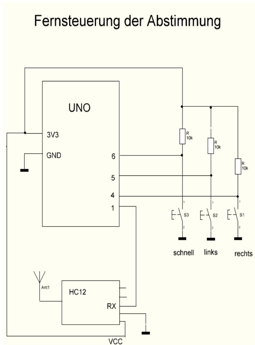
Man kann auch andere Arduinos einsetzen. Der Mikroprozessor wird über das Koaxkabel gespeist. Ebenso die aktive Elektronik
