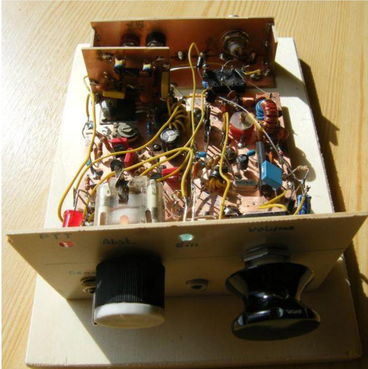
Links unten ist die PTT als Kippschalter gerade noch zu erkennen. Zur Verbindung mit Kopfhörer und Taste habe ich Buchsen für Klinkenstecker 3,5mm vorgesehen. Man erkennt am Schwingkreis des RX noch einen kleinen C-Trimmer. Doch der Kreis ist breitbandig und man kommt ohne Abstimmung aus. Das Filter am Senderausgang ist auf einer senkrecht stehenden Platine untergebracht.
