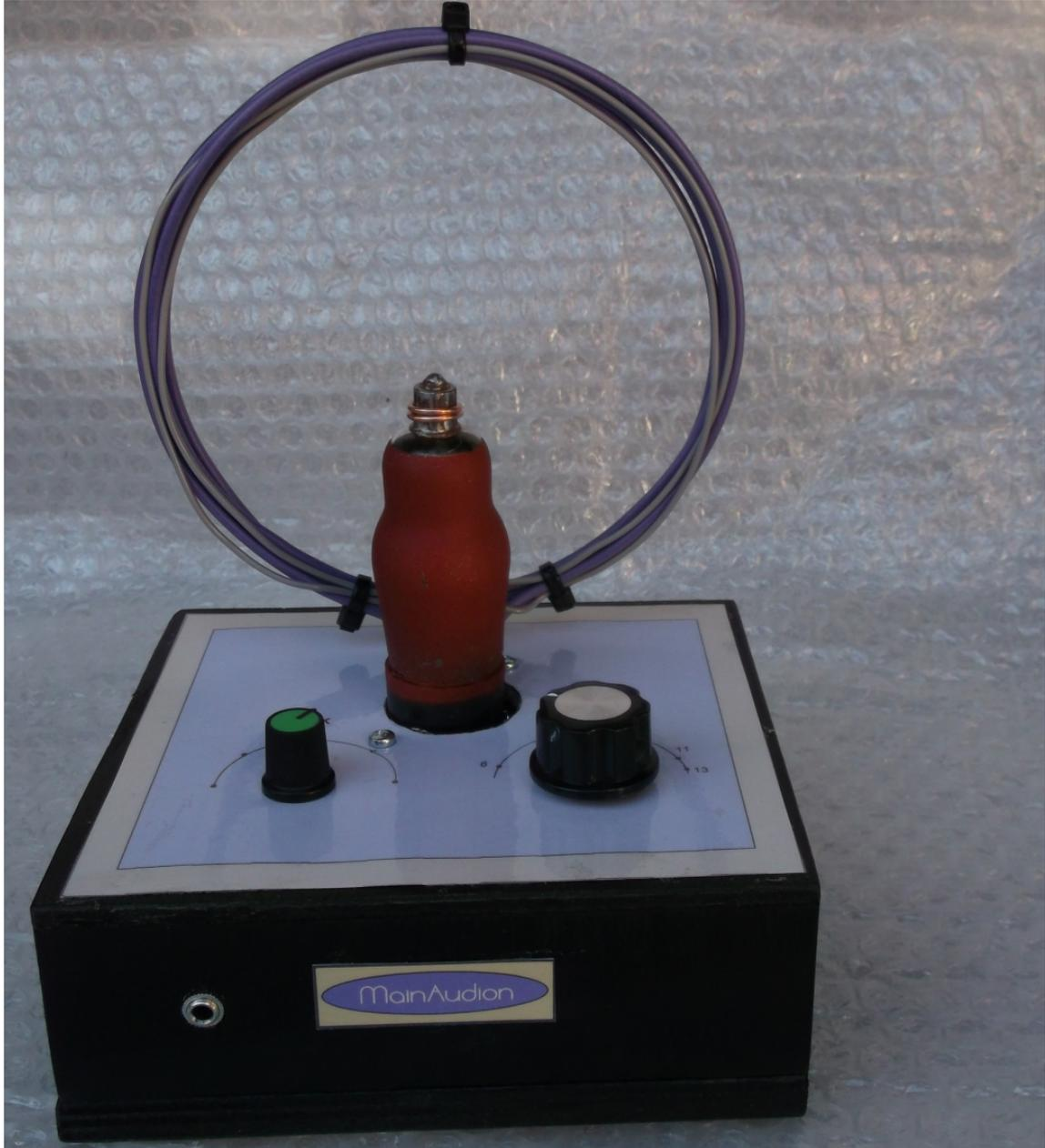
Ohne Zweifel ist die EF 9 (rote Serie von Philips) eine sehr schöne Röhre. Das Nostalgische ist stärker ausgeprägt als bei der EF 80. Allerdings ist auch der Aufwand bei der Befestigung der Röhre größer. Ein Sockel mit Außenkontakten ist kaum preiswert zu beschaffen. Die Brummempfindlichkeit ist höher als bei der EF 80. Der Betrieb an einem Netzteil daher eigentlich nicht zu empfehlen. Ein 12V-Akku wäre hier die bessere Lösung für eine brummfreie Stromversorgung.
