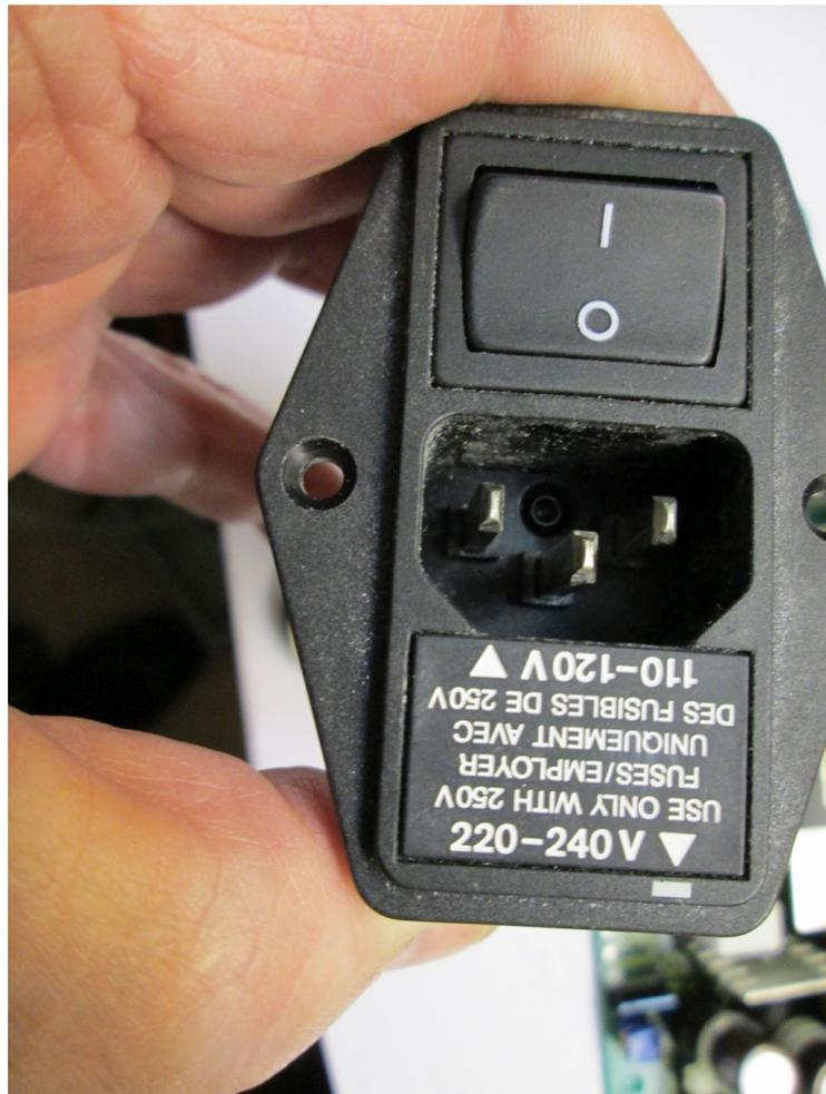
Es ist da ein kleiner Einschub in diesem Filtergehäuse. Man kann ihn um 180 Grad drehen und so auf 110...120V umschalten. Den zog ich heraus. Und dann sah ich endlich, woher der rätselhafte Knall kam. Es war darin eine vorgeschaltete Sicherung durchgebrannt. Also doch ein perfekter Schutz. So eine lange Type mit 3A/250V. Ich fand sie in meinem Vorrat. Ist eben doch gut, wenn wenn man alles aufhebt,hi.
