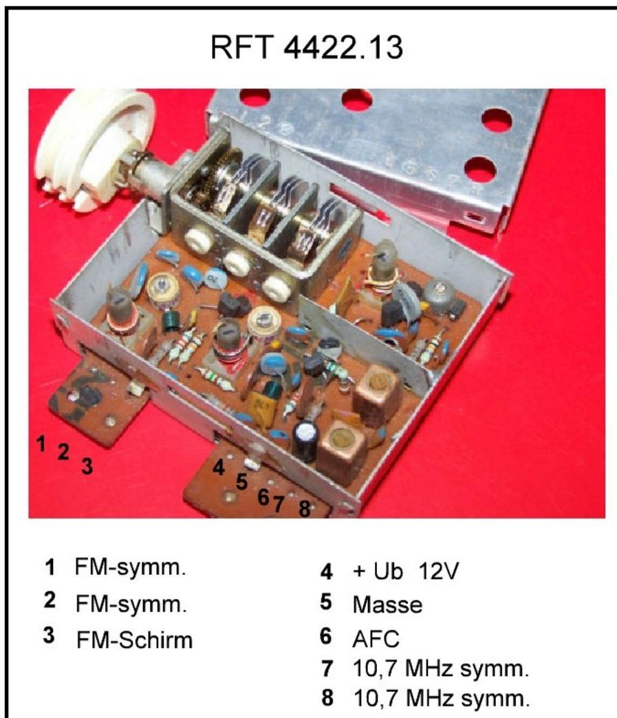
Im ausgebauten Zustand konnte ich auch die Transistoren überprüfen. Es sind NPN-Typen. Nur der Oszillator hat eine Abstimm-diode für die AFC. Die Vorstufe und die Mischstufe sind ohne Kapazitätsdioden.
