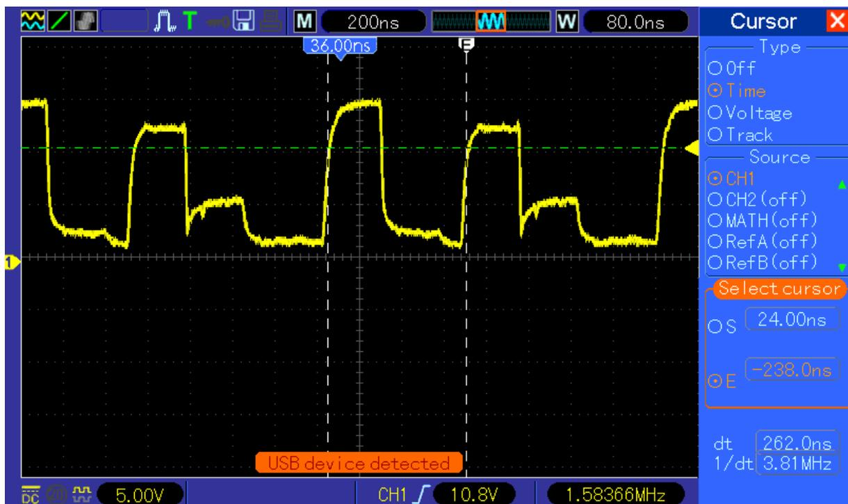
Das letzte Foto zeigt den reflektierten Impuls bei offenem Ende. Die Laufzeit in einer Richtung ist  $262 \text{ ns} / 2 = 131 \text{ ns}$ . Mit dem Verkürzungsfaktor berechnen wir die Wegstrecke für eine ns im Kabel:  $0,29972 \text{ m/ns} \times 0,66 = 0,1978 \text{ m/ns}$ . Nun multiplizieren wir die Laufzeit mit  $0,1978 \text{ m/ns}$  und erhalten die Länge:  $131 \times 0,1978 = 25,91 \text{ m}$ .
