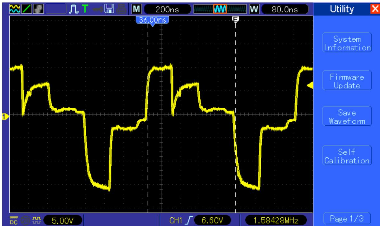
Man erkennt eine positive Reflexion kurz hinter dem Impuls. Hier vermute ich eine Stoßstelle. Der folgende negative Impuls ist die eigentliche Reflexion vom Kabelende.
