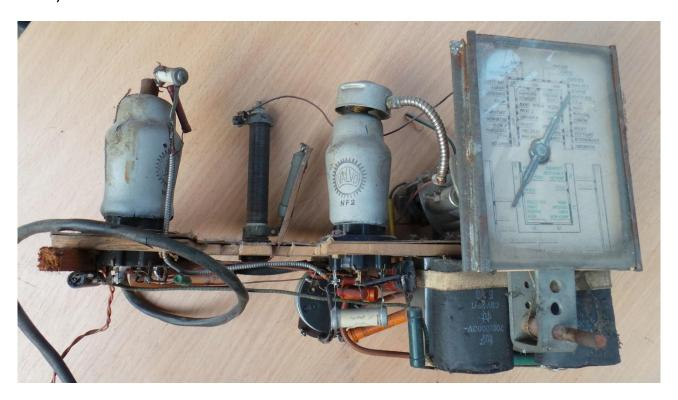
Der Drehkondensator hat 600 pF. Über einen einfachen Seiltrieb wird der Zeiger bewegt. Die Skala war arg verschmutzt und zeigte folgende Sender:
