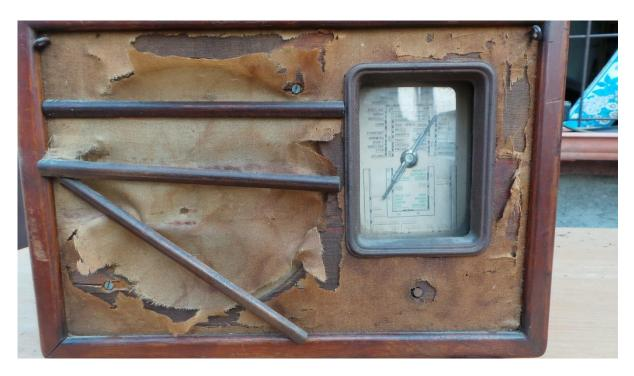
Die Stoffbespannung war zerrissen, das Gehäuse allerdings noch gut erhalten.
