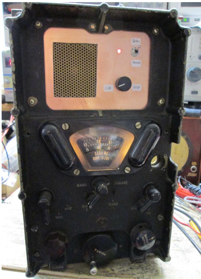
Der LM386 hat eine sehr hohe Eigenverstärkung. Und seine Grenzfrequenz ist ebenfalls im HF-Bereich. Man muss abblocken. Damit geht man Problemen aus dem Weg. Die Ausgangsleistung ist aber gut. Jedenfalls besser als bei den Billigprodukten aus China, die mit ICs im Schaltbetrieb arbeiten.
