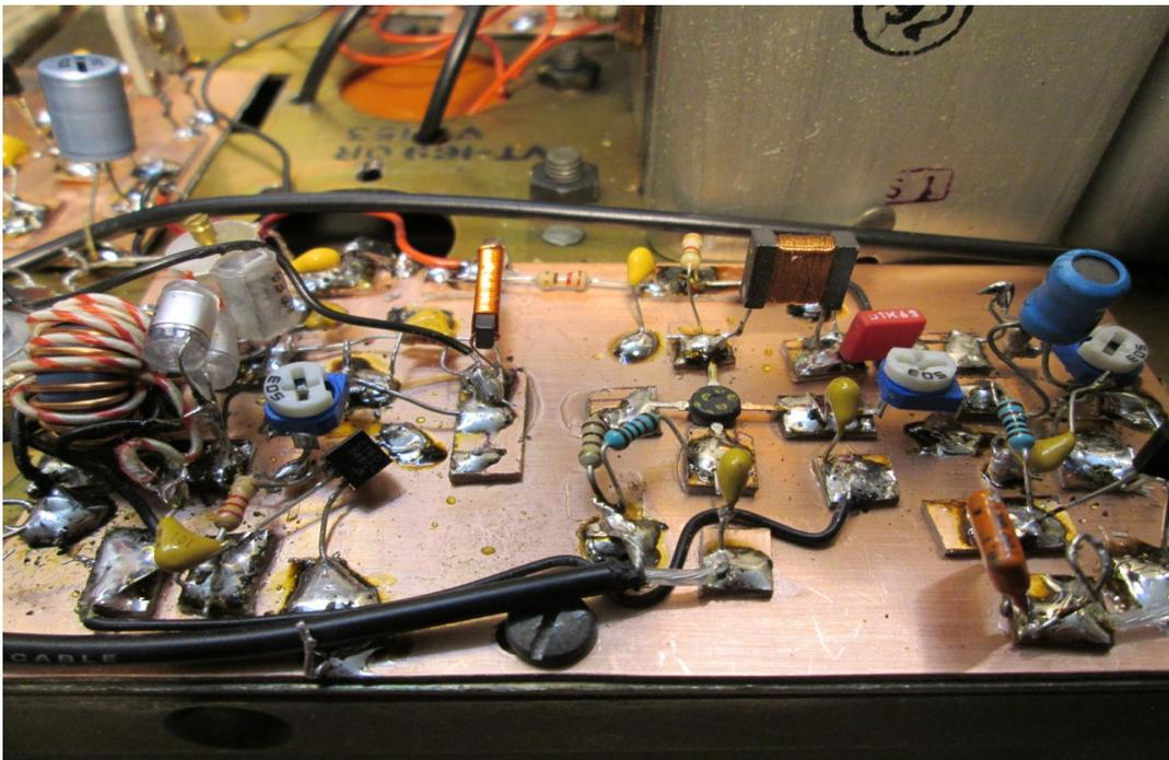
links der BFO, rechts der Produktdetektor
