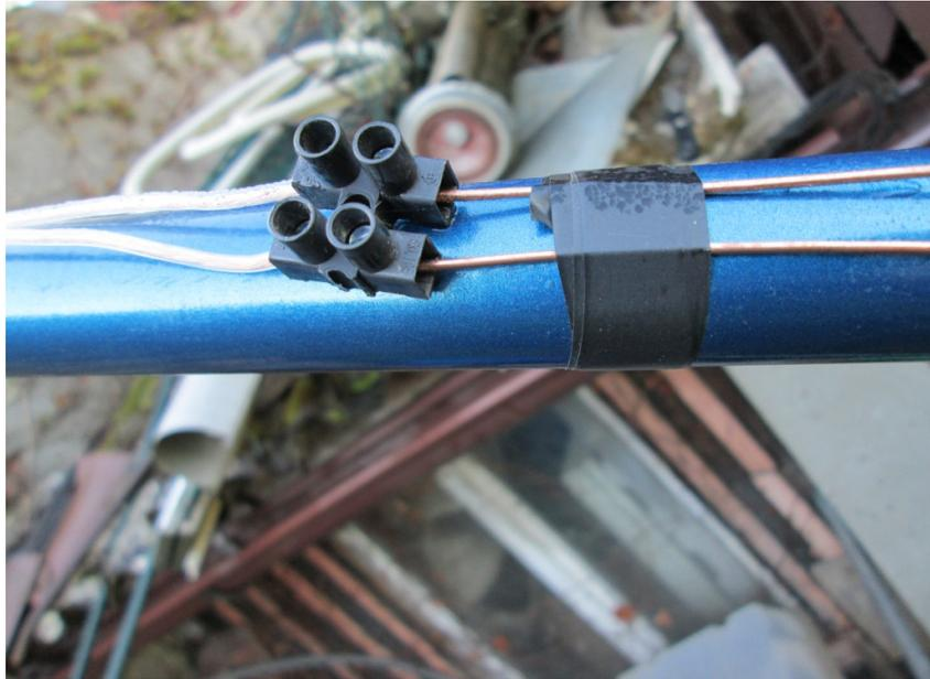
Den Rest der Paralleldrahtleitung machte ich mit der übrig gebliebenen Lautsprecherlitze. Den Strahler und diesen Restdraht bis zur Länge 145cm verbindet man einfach wieder mit einer Lüsterklemme. Könnte man auch löten. Aber wer hat schon einen Lötkolben im Garten?
