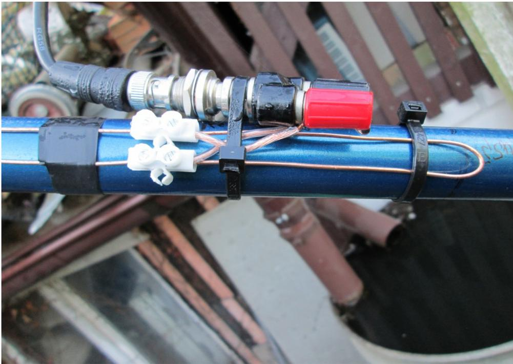
Die Drähte steckte ich durch eine Lüsterklemme. Die kann man bei der Abstimmung auf dem Paralleldraht verschieben und das Koaxkabel anklemmen. Den im Bild sichtbaren Labor-Adapter sollte man nur bei trockenem Wetter einsetzen. Besser ist eine feste Klemmverbindung. Allerdings achte man darauf, dass man „von oben“ das Koaxkabel anschließt, damit das Regenwasser nicht darin eindringen kann. Also eine Schleife(Biegung) mit dem Koaxkabel machen und das ganze mit Kabelbindern am Mast befestigen.
