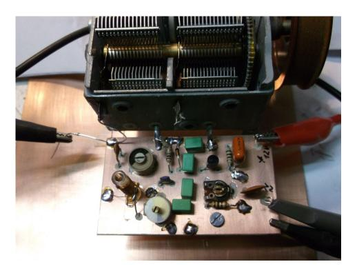
Zunächst stellte sich die Bereitstellung von +10 dBm Pegel als kleines Problem dar. Ein Treiber mit einem BF 990 koppelt wegen der geringen Eingangskapazität lose an die Schwingschaltung mit einem BF 245 an. Mit einem Transformator T1-1 von Minicircuits koppelte ich vom Drain über ein 3 dB-Pi-Dämpfungsglied in den Mischer.
