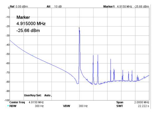
Am Eingang des Quarzfilters ist ein Pegel von -50 dBm:
