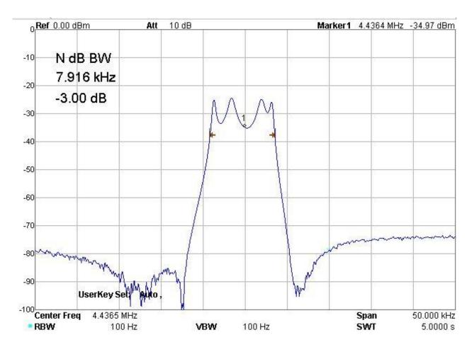
Allerdings müssen die Quarze sorgfältig ausgewählt werden, wenn man eine geringe Welligkeit erzielen will. Die steilen Flanken sind der große Vorteil hinsichtlich der Trennschärfe, die die Sender wie in Kanalfiltern reinbringt. Bei den sonst üblichen Bandfiltern mit LC-Schwingkreisen lassen sich seitliche Überdeckungen eben nicht so einfach vermeiden. Hier aber ist selbst ein sehr schwaches Signal neben einem starken einwandfrei zu hören.
