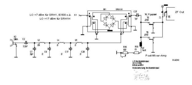
Der Schaltungsvorschlag stellt ein bekanntes Konzept dar. Man findet im Netz verschiedene Abwandlungen. Bemerkenswert ist der korrekte Abschluss des Mischers mit zwei J 310. Da die üblichen Ringdiodenmischer den Oszillatorpegel nur mit 52 ...57 dB zum ZF-Ausgang isolieren, muss man einen Tiefpass nachschalten. In meinem Fall waren bei +7 dBm Oszillatorleistung noch 1,7 mVeff am Ausgang zu messen. Zugleich dient dieser TP auch zur optimalen Anpassung an das Quarzfilter.
