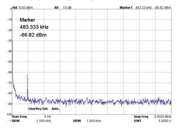
Bei 483 kHz ist das Empfangssignal von 500 kHz mit -50 dBm. Der Tastkopf hatte hier in Stellung 10 :1 15 dB Dämpfung.
