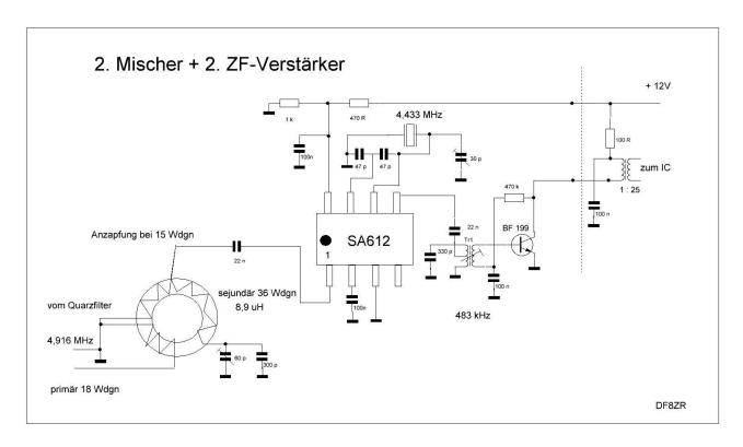
Es lag auf der Hand, einen zweiten Quarz zu verwenden. Durch die Mischung mit einem PAL-Quarz kommen ca. 480 kHz als zweite ZF heraus. Ideal, um ein bewährtes Filter aus der Transistortechnik(roter Kern) einzusetzen. Mit einem BF 199 machte ich die zusätzliche Verstärkung. Jetzt steht am TDA 1072 praktisch der Pegel am Antenneneingang des Empfängers. Wie gut die Selektion ist, zeigt das folgende Bild:
