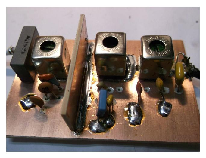
Die Metallbecher sind von ehemaligen ZF-Filtern und schirmen die Spulen ab. Am Antenneneingang schützt ein spannungsfester Kondensator(0,22 uF/ 250V) die Schaltung.
