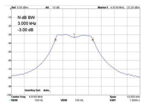
Mit einer Bandbreite von 3 kHz kann man zwar Sprache gut hören, jedoch die Musik klingt einfach zu dumpf. Das Diagramm zeigt einen brauchbaren TopFlat. Bedingt durch das Messen mit Oszilloskop-Tastköpfen ist eine Dämpfung von 10 dB zu beachten. Der Trace war -20 dBm. Das Filter hatte deshalb kaum eine Eigendämpfung und die Welligkeit war maximal 3 dB. Eigentlich ein gutes Filter, das mir hier auf Anhieb gelungen war.
