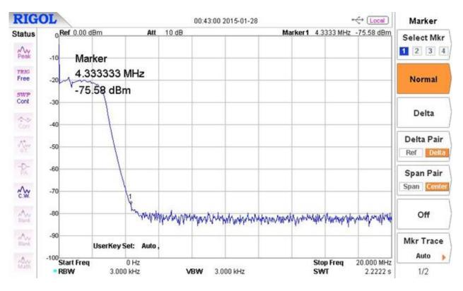
Bei 5 MHz ist die Sperrdämpfung 60 dB. In dem Frequenzbereich der ZF(4,915 MHz) sollten in Europa kaum Sender in Betrieb sein. Falls am unteren Ende des Empfangsbereiches starke Langwellensender durchschlagen sollten, muss man das Antennenfilter um einen zusätzlichen Hochpass erweitern.
