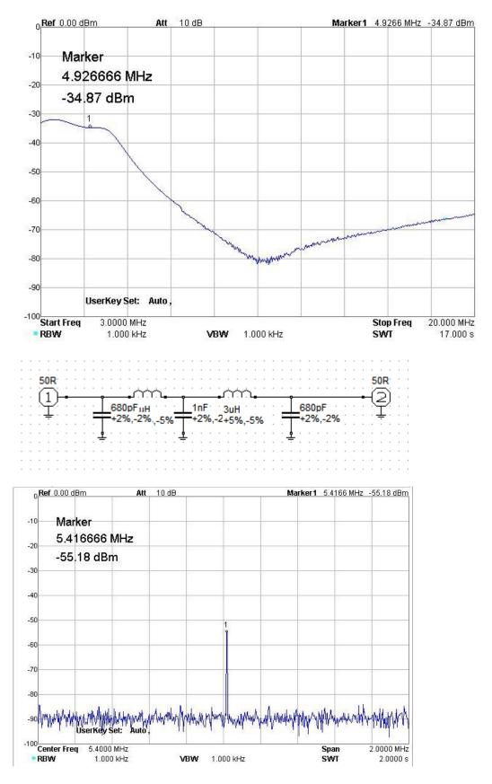
Etwa -50 dBm Oszillatorpegel(5 dB hat der Tastkopf!) sind noch am Eingang vom Quarzfilter. In der 50 Ohm-Technik(niederohmig) sind Einstreuungen eher seltener, sodass man mit einem störungsfreien Betrieb rechnen kann.
