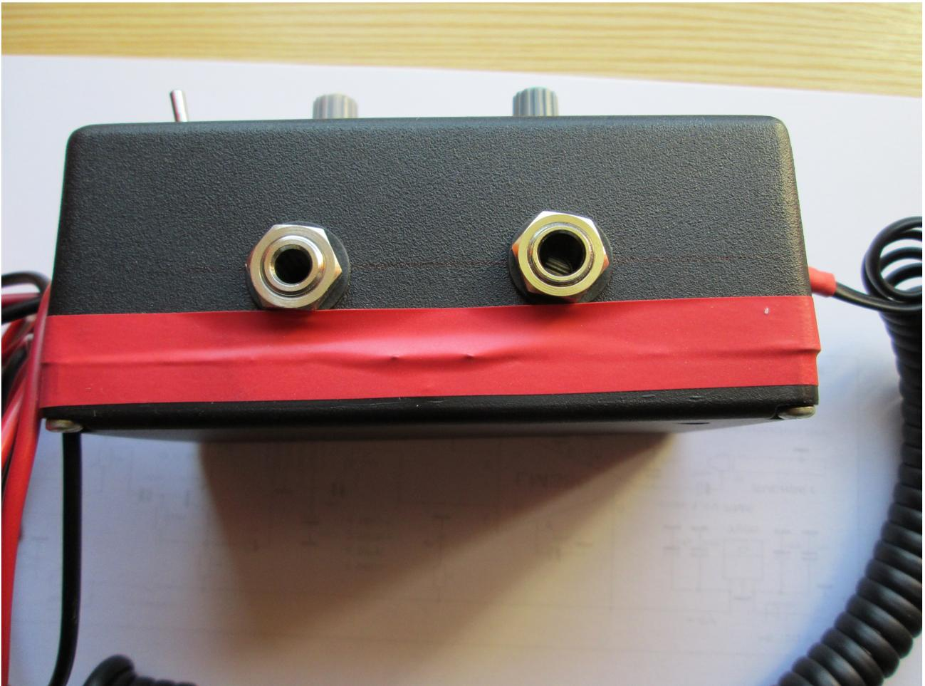
Links die 5mm Mikrofonbuchse, rechts die 6,3mm für den Kopfhörer
